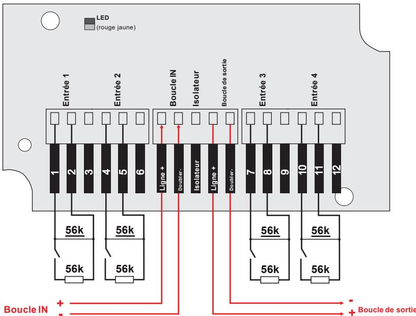
Sans utiliser le module isolateur intégré.
