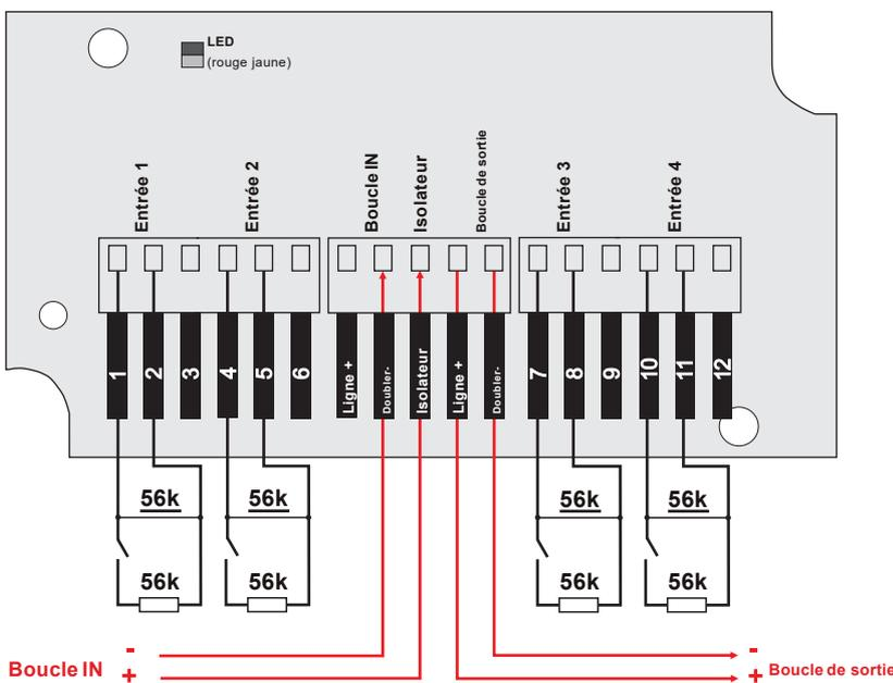
Avec l'utilisation du module isolateur intégré.
